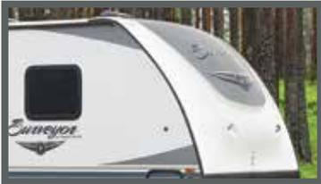
TRAVEL TRAILER GEL-COAT FIBERGLASS CAP (N/A EXPANDABLES AND LE MODELS).
