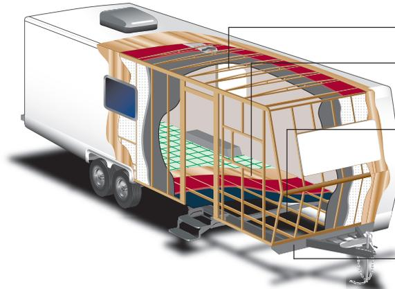
**ENGINEERED RADIUSED CEILING TRUSS**
